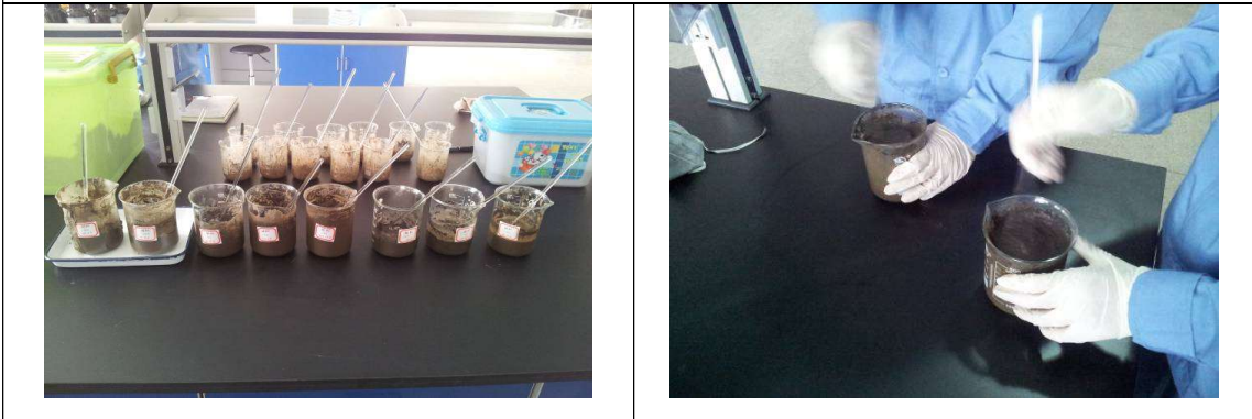
图 4-7 污染土壤加药剂后搅拌
